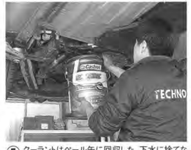
⑤ クーラントはバール缶に回収した。下水に捨てないためだが、今回は全量が抜けたか判断するため量を確認する目的もある
