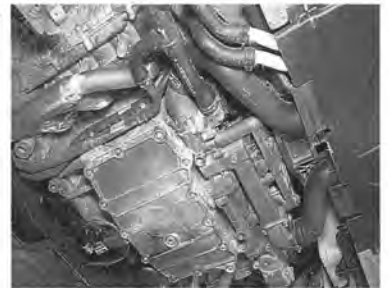
① モデル車のボクスターははずかだがウォーターポンプから漏れがあったので、ウォーターレスエンジンクーラントを充填する前に交換する
