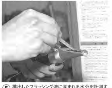
⑤ 排出したフラッシング液に含まれる水分を計測する。比重系で比重を計り、換算表に当てはめることで簡単に分かるのだ
