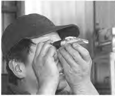
⑥ このときはフラッシング液に含まれる水分量が多かったため、フラッシングを2回行った
