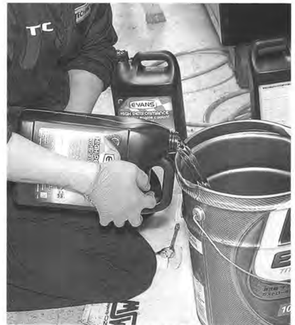
⑦ いよいよウォーターレスエンジンクーラントを入れる。色は麦茶のような薄茶色で、常温では通常のLLCより粘性が高い。しかし高温になれば粘性は低下するので、ウォーターポンプなどに負担をかけることはない
