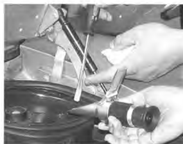
⑨ 最後に比重計で水分含有量をチェックし、間違いなく3%以下になっていることを確認して作業は完了だ
