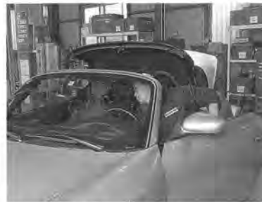
② ほとんどの作業はボディの下から行うが、ウォーターポンプ交換にあたってベルトを外す必要があるため、上側も開ける
