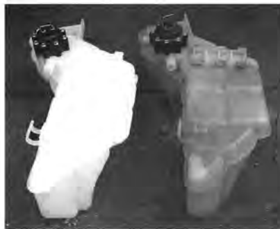
これは911のエキスパンションタンクで左が新品。右は漏れが発生しているもの。このタンクは交換することがよくあるが、そうするとクーラントも交換となる。
