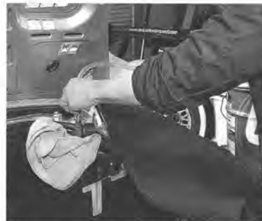
⑧ またウォーターライン内のエアを吸引してウォーターレスエンジンクーラントを充填する
