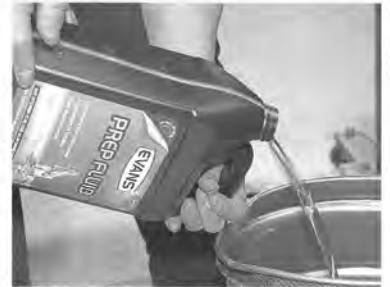
① 専用のフラッシング液「プレップフルード」を入れる。これは透明に近い液体で、何回か再使用することができる
