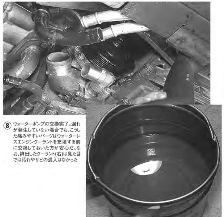
⑥ たくさんの配管を外して、ようやくウォーターポンプが見えてくる。交換はかなりやりにくい
