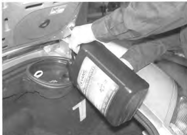
作業終了後は特にメンテナンスは必要ないが、通常のLLCと違って、もし減ったら水を継ぎ足す、といったことはできない(緊急時には水を入れてもいいが、後ほど全量交換が必要になってしまう)。911、ボクスターはエアが抜けにくいということもあるので、念のために補充用のウォーターレスエンジンクーラントを数リットル用意しておく安心だ
