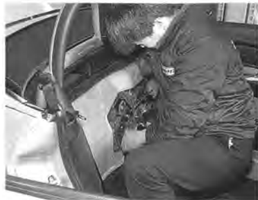
③ シートの後ろのメンテナンスホールを開け、ベルトを外す。この作業とクーラントの充填以外の作業はすべてボディ下から行う
